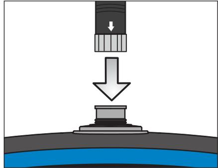
图 6 连接插入管
